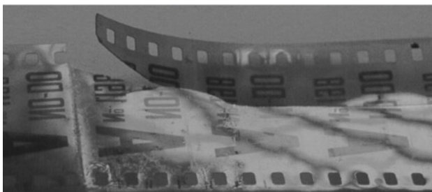
Película deformada y cristalizada (y, por último, desgarrada) por la agresión química de pegamento.
