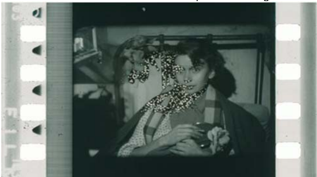
172.3. Quemadura en las zonas de alta densidad del círculo central del fotograma, en toda la película, por fallo del filtro anticalórico de los proyectores.
