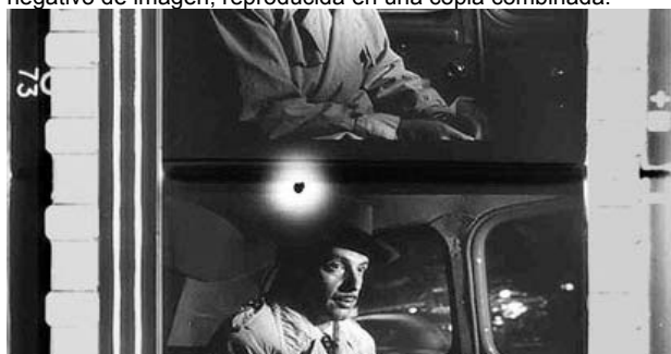
170.3. Mancha producida durante el procesado del negativo de imagen, por la acción del revelador retenido en torno a una mota de polvo. El punto negro central corresponde al vacío dejado por la propia mota de polvo.
